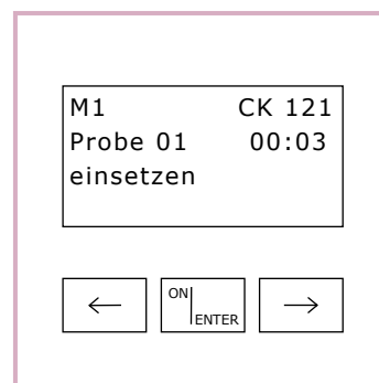
6. Folge dem Display und stelle Probe 1 in das Photometer Es erscheint die Anzeige „Mess“, warte 10 Sekunden bis die Anzeige „Mess“ erlischt, entferne danach die Küvette und inkubiere sie erneut Mit allen weiteren Küvetten in gleicher Weise verfahren Danach ON/ENTER drücken
