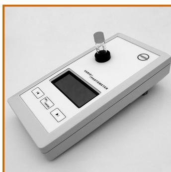
**8.** Messwert der 1. Küvette ablesen, Küvette entfernen
