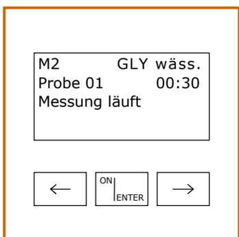
**7.** Zuerst ON/ENTER drücken und erst **danach** die **1.** Küvette in das Photometer stellen
