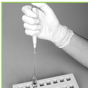
**2.** Probe mit Mikropipetter ausstoßen und mehrfach spülen
