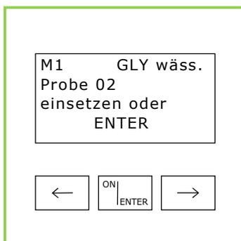
**5.** Nullpunkteinstellung: Küvette mit Probe (Bild 3) in das Photometer stellen, Nullpunkt wird vom Gerät gespeichert
