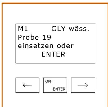
**4.** Nullpunkteinstellung: Küvetten mit Probe (Bild 2) nacheinander in das Photometer stellen
