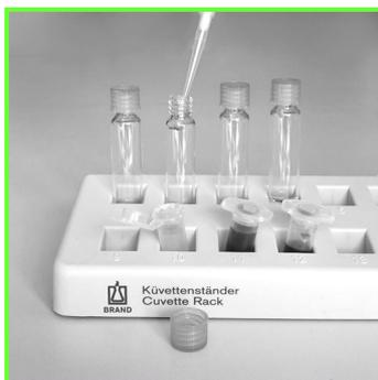
**2.** Proben in die Küvetten pipettieren, gut mischen und 10 Min. stehen lassen
