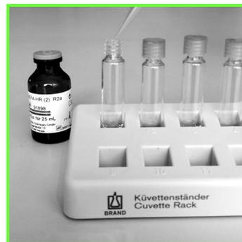
**3.** Nach Ablauf der Wartezeit von 10 Minuten 500  $\mu\text{L}$  Lösung R2a aus der Flasche in jede Küvette pipettieren
