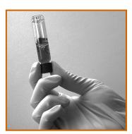
2. Verschlusskappen wieder aufschrauben Küvetten mehrmals über Kopf schwenken
