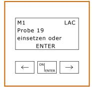
**4.** Nullpunkteinstellung: Küvetten mit Probe (Bild 2) nacheinander in das Photometer stellen
