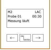
7. Zuerst ON/ENTER drücken und erst **danach** die 1. Küvette in das Photometer stellen Zeitablauf wird angezeigt, Messwert abwarten
