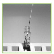
1. Kapillare mit 10 µL Probe in die geöffnete Küvette stellen
