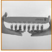
**6.** Alle Küvetten **gleichzeitig** mehrmals über Kopf schwenken
