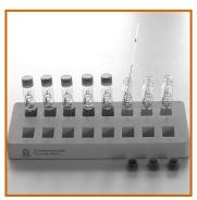
1. Die Proben in den Kapillaren nacheinander mit dem Mikropipetter in die Küvetten ausstoßen und mehrfach spülen
