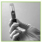
**3.** Verschlusskappe wieder aufschrauben Küvette mehrmals über Kopf schwenken
