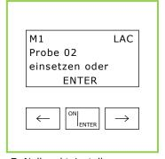
**5.** Nullpunkteinstellung: Küvette mit Probe (Bild 3) in das Photometer stellen, Nullpunkt wird vom Gerät gespeichert Nach Signalton Küvette
