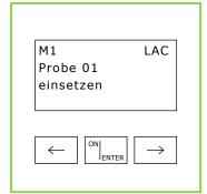
**4.** Gerät mit ON/ENTER einschalten Gerätecheck abwarten, mit ON/ENTER bestätigen Gewünschten Test auswählen, mit ON/ENTER bestätigen
