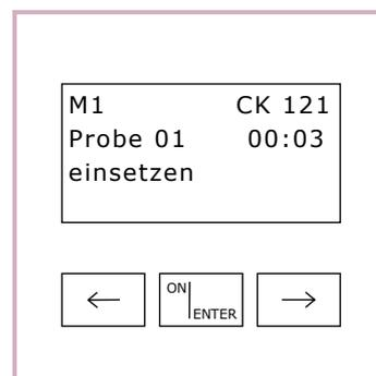
**6.** Folge dem Display und stelle Probe 1 in das Photometer
